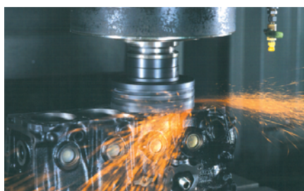
スミボロンチップによる 鋳鉄切削 Cast iron cutting by SUMIBORON inserts
