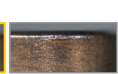
他社コーテッドCBN 膜剥離、チッピングが発生 Competitor's coated CBN Peeling and chipping occur
