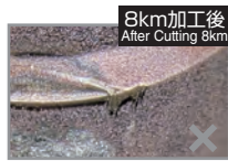
従来コーテッドCBN 境界摩耗発生 Notch wear occurs
