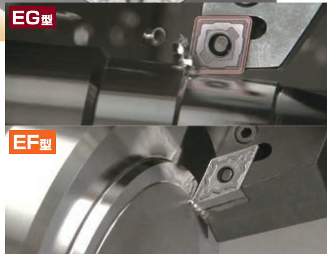
上: EG型ブレード+AC510Uの外径粗加工 (インコネル718) Upper photo: Outer roughing with EG Type Chipbreaker+AC510U (Inconel 718) 下: EF型ブレード+EH510の端面仕上げ加工 (Ti-6Al-4V) Lower photo: Face finishing with EF Type Chipbreaker+EH510
