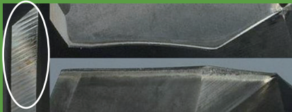
切削条件: f=0.30\text{mm/rev} 切削長: 30m (加工時間39分) Cutting Conditions Cutting Length Time Min.
