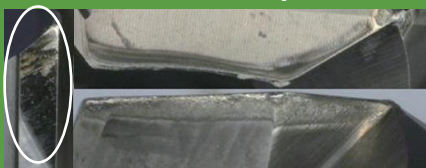
切削条件: f=0.60\text{mm/rev} 切削長: 60m (加工時間39分) Cutting Conditions Cutting Length Time Min.
