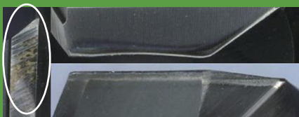
切削条件: f=0.30\text{mm/rev} 切削長: 30m (加工時間39分) Cutting Conditions Cutting Length Time Min.
