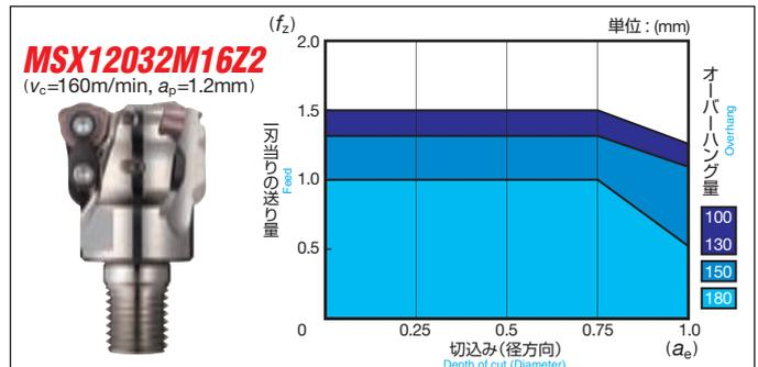
(注) 上記表は条件選定の目安を示します。条件選定の際は、機械剛性・ワーク剛性に応じて調整して下さい。
